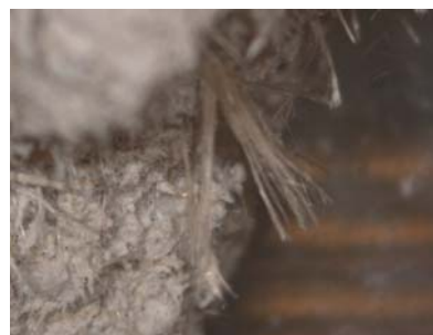
Figura A1.5 Material con amianto AMOSITA (60 X)
