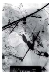
Figura A1.11 Fibras de amianto en aire recogidas en filtro para recuento (Microscopía electrónica 2000X)
