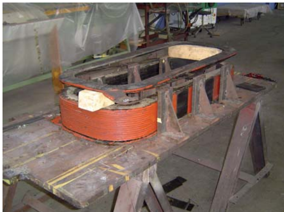
Figura A1.35 Aislamientos eléctricos en una bobina
